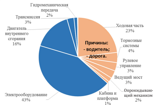
Рис. 4. Структура причин поломок деталей автосамосвалов БелАЗ
