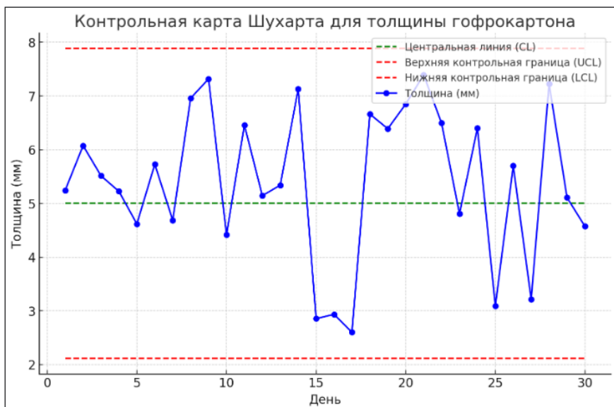
Рис. 1. Контрольная карта измерения толщины гофрокартона
