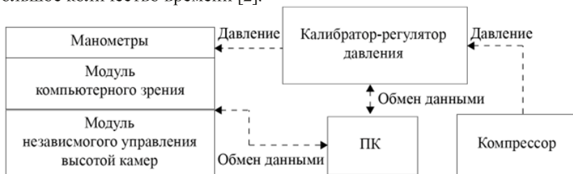
Рис. 1. Блок-схема автоматизированной системы управления
