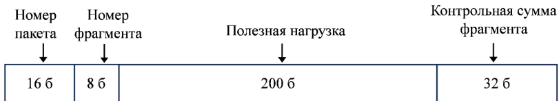
Рис 2. Структура основного фрагмента пакета
